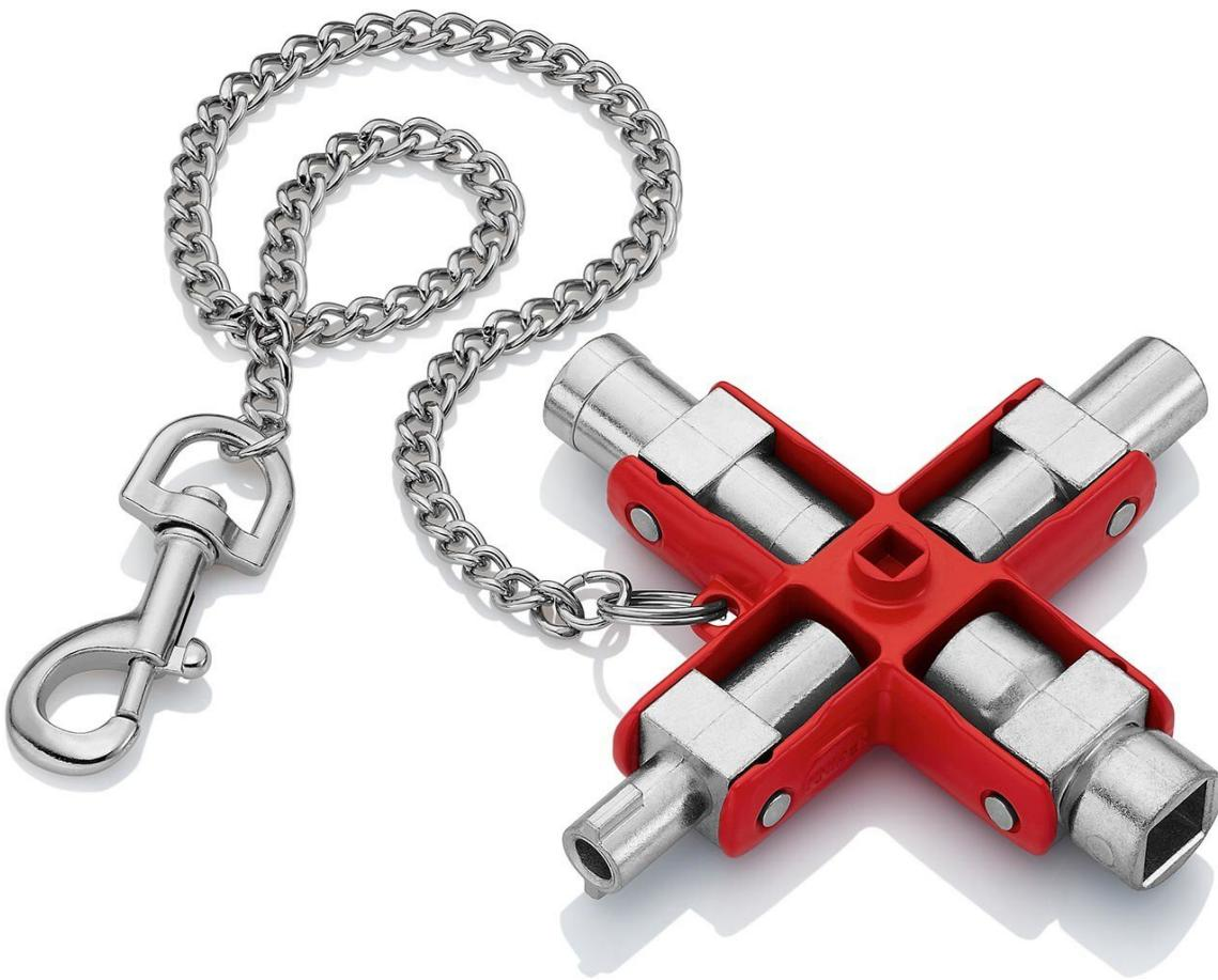
Pour les systèmes de fermeture dans l'électrotechnique, l'approvisionnement en gaz et en eau, la climatisation et la ventilation, l'industrie, la technique du bâtiment, etc. Neuf fermetures différentes en zinc moulé sous pression dans une seule clé. Avec chaîne amovible et mousqueton. Longueur totale du bras : 90 mm. - Capacité carré : 5,0 / 6,0 / 7,0 - 8,0 / 9,0 - 10,0mm - Capacité double panneton : 3 - 5mm - Capacité demi-lune : 6mm - Capacité triangulaire : 7,0 / 8,0 - 9,0 / 10,0 - 11,0mm
