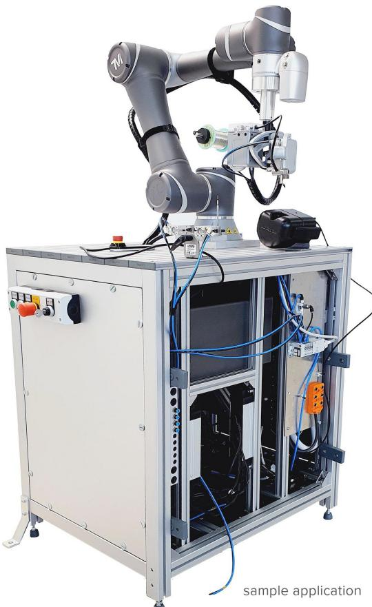
La station de travail mobile TM avec zone de travail intégrée - utilisable individuellement et de manière flexible. La commande est rangée à l'intérieur de la station de travail et est facilement accessible par des ouvertures latérales. En option, avec automate programmable intégré, raccords d'air comprimé et kit TP-100-1 TM.
