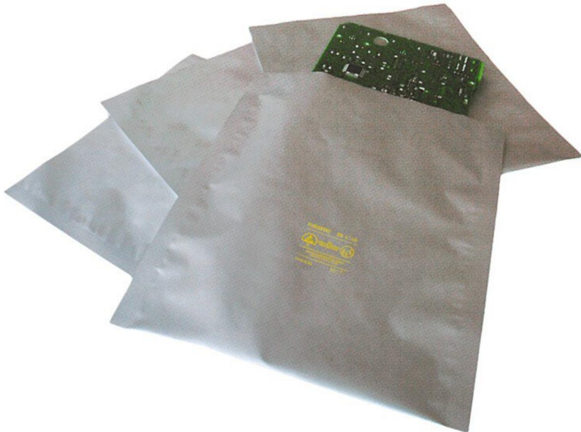
Le sac de protection ESD/EMI de SafeGuard est scellable et peut être mis sous vide, et, grâce à sa conception multi-couches, protège de l'humidité les composants électroniques sensibles et présente une perméabilité définie à la vapeur d'eau. Le sac ESD comporte toujours la désignation de type, le symbole d'avertissement ESD, le symbole de recyclage, et le numéro de lot.
