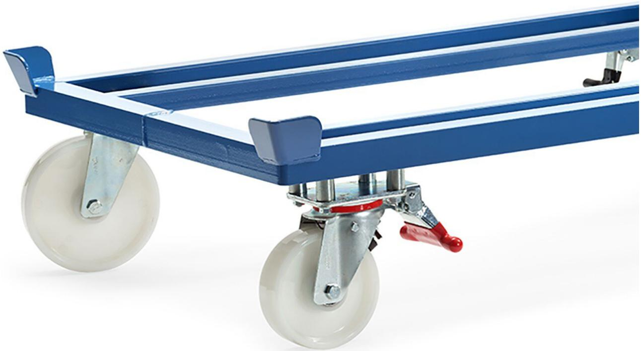
Leviers d'actionnement fixes sous le cadre, ne dépassant pas. Commande depuis le côté longitudinal. Bonne accessibilité dans chaque position des roulettes. La hauteur d'encastrement passe à 237 mm, la hauteur totale à 282 mm. Au lieu de 2 roues pivotantes, avec des freins normaux.
