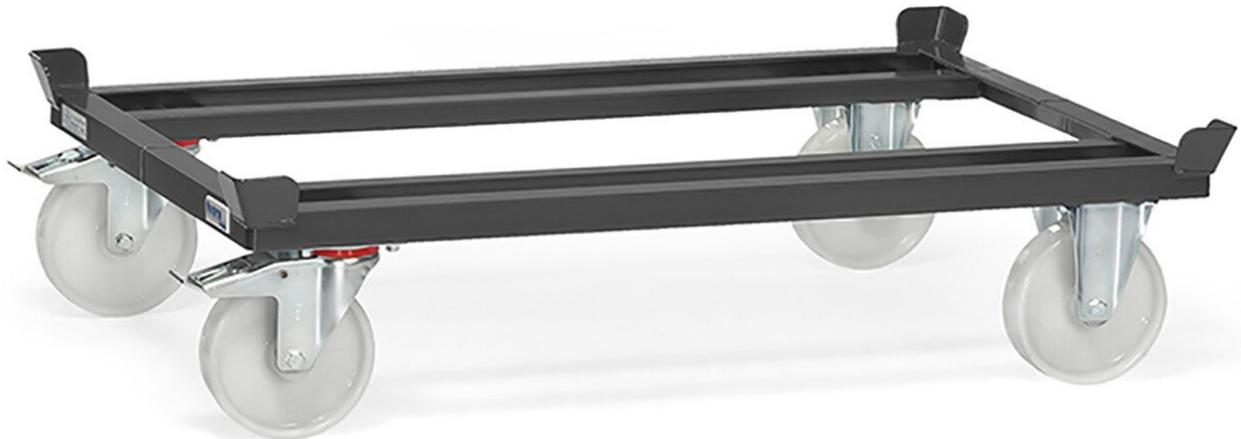
Pour palettes plates et caisses grillagées. Construction robuste en acier soudé à cornières, avec 4 coins d'accrochage, revêtement par poudre, gris anthracite RAL 7016. 2 roues pivotantes et 2 fixes, roues en polyamide, moyeu à roulement à rouleaux, freins sur les roues pivotantes, conformes à la norme européenne EN 1757-3 (sécurité des chariots de manutention). Faible résistance au roulement, haute résistance aux produits chimiques, non marquant = ne laisse pas de traces. Bruit de roulement.
