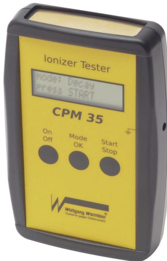
Le CPM 35 est un appareil de mesure maniable pour la vérification entièrement automatique des ionisateurs. vérification des ionisateurs au poste de travail ESD ou dans les machines. Il mesure les décharges positives et négatives ainsi que les tensions de décalage et peut en outre être utilisé pour mesurer périodiquement les charges de personnes (walking test).
