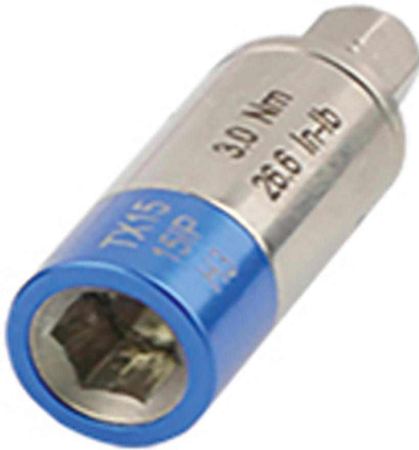
couple préréglé, tolérance de précision +/-10%. précis et exact, pour 20.000 clics. En combinaison avec un outil électrique, vitesse max. 100 tr/min.
