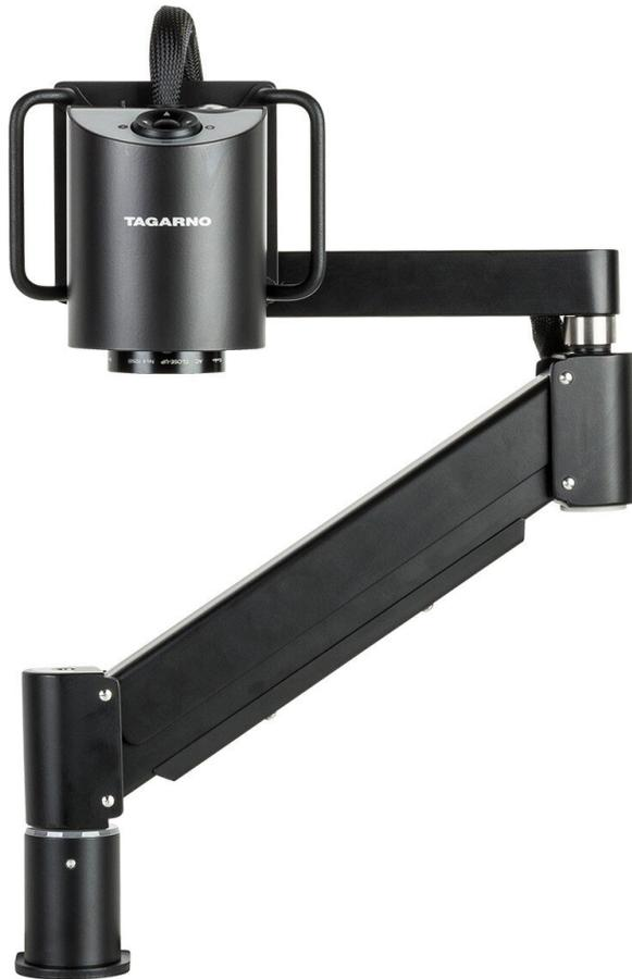
Le microscope numérique et système d'inspection ZAP Flex de Tagarno séduit par son zoom optique 30x, sa fréquence d'images ultra-élevée de 60 fps, son grossissement jusqu'à 133 fois et sa qualité d'image 1080p. Le microscope numérique TAGARNO ZAP est un microscope puissant et flexible, qui est également équipé d'un pointeur laser. Le kit comprend le microscope ZAP, le boîtier de commande XKEY, un objectif avec zoom 4x (4+) et un bras flexible avancé.
