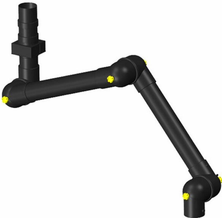
Le système Alsident® 75 antistatique est en outre homologué pour l'utilisation dans les zones ESD/Ex (zones ATEX) selon les normes suivantes : EN 80079-36-2016 et EN 80079-37-2016 et est donc marqué par : Ex II 1 GD. Le Système 75 antistatique d'Alsident® est donc équipé d'un fil de terre. Pour les zones ESD, une ligne de terre avec une résistance de 1MΩ est également fournie.
