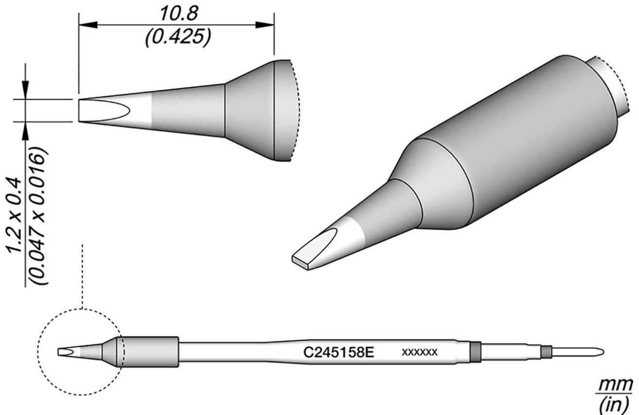
Pointes à souder de la série C245 pour fer à souder T245 (anciennement AD-2245). Ils conviennent à des fins de soudure générale. Mode sommeil et repos dans le plateau.
