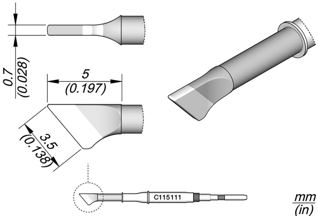
Les pointes à souder de la série C115 sont adaptées à la soudure et à la réparation de très petits composants. Ils sont compatibles avec les pièces à main de soudure NT115-A, NP115-A et AN115-A Nano.
