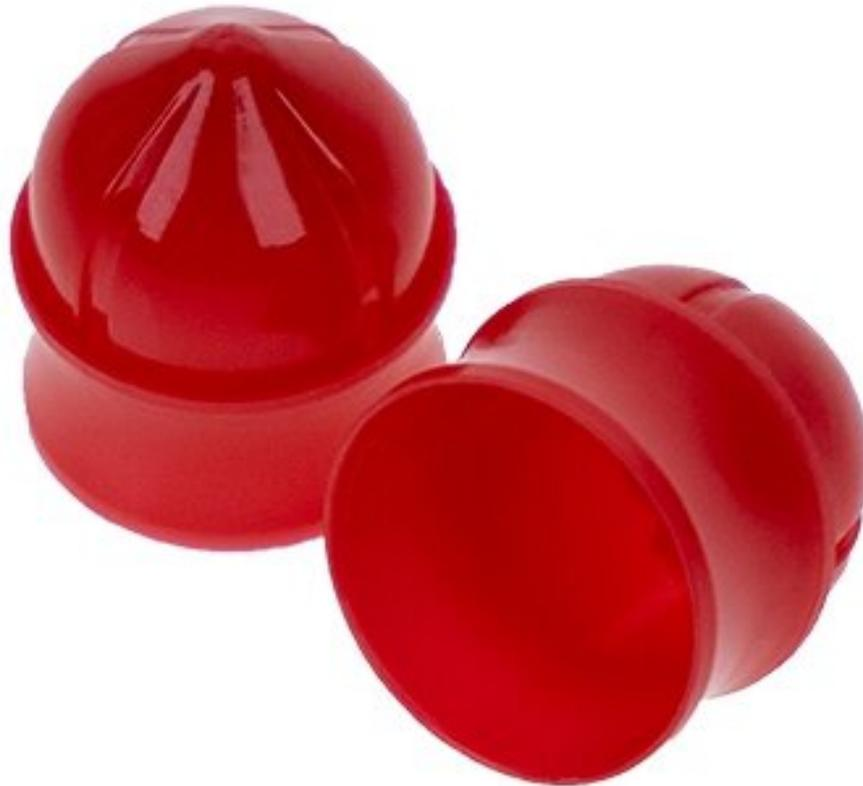
Un piston est inséré dans la cartouche après qu'elle a été remplie de liquide afin d'assurer un dosage uniforme, d'empêcher la formation de gouttes et d'éviter les déchets en essuyant les parois de la cartouche lors du dosage du liquide. Les pistons Optimum sont moulés en polyéthylène haute densité.
