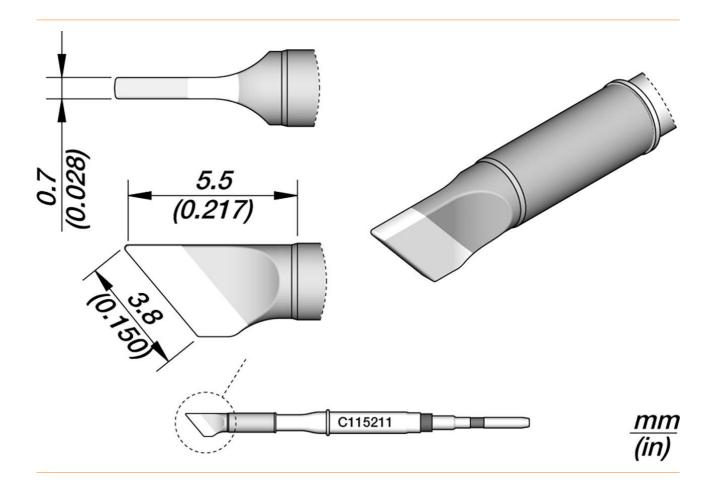
Les pannes à souder de la série C115 conviennent pour le soudage et la réparation de très petites pièces. Elles sont compatibles avec les nano-pièces à main NT115-A, NP115-A et AN115-A.
