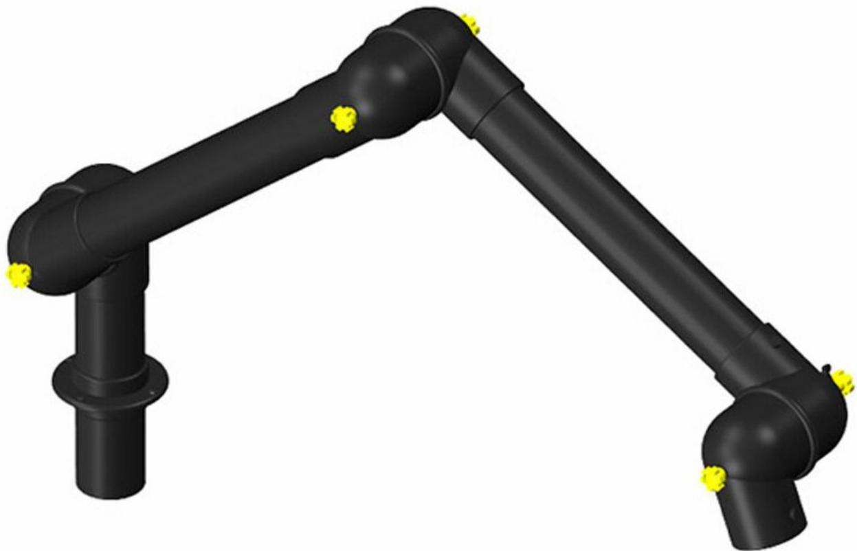
Le système d'aspiration Alsident DN 100 est particulièrement adapté aux grandes quantités de matières toxiques, ou aux tâches de captage plus importantes. Les tuyaux ont un diamètre de 100 mm et le volume d'air recommandé pour l'aspiration est compris entre 140 m<sup>3</sup> / h et 400 m<sup>3</sup> / h. Le système ESD est fourni avec un conducteur de mise à la terre ayant une résistance de 1MΩ.
