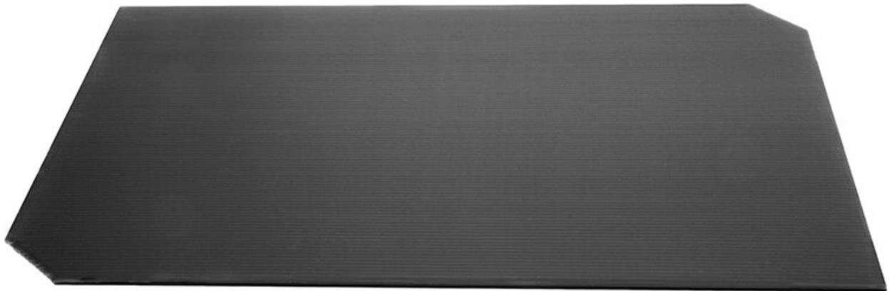
Les intercalaires Safeguard ESD en noir pour bacs Euro de 600 x 400 mm sont composés d'un matériau creux conducteur de volume (polypropylène). Ce matériau se caractérise avant tout par un faible poids propre et une grande résistance à l'abrasion. Les dimensions des intercalaires sont L x l x H = 553 x 353 x 3 mm. Chaque intercalaire a deux coins biseautés qui facilitent le retrait.
