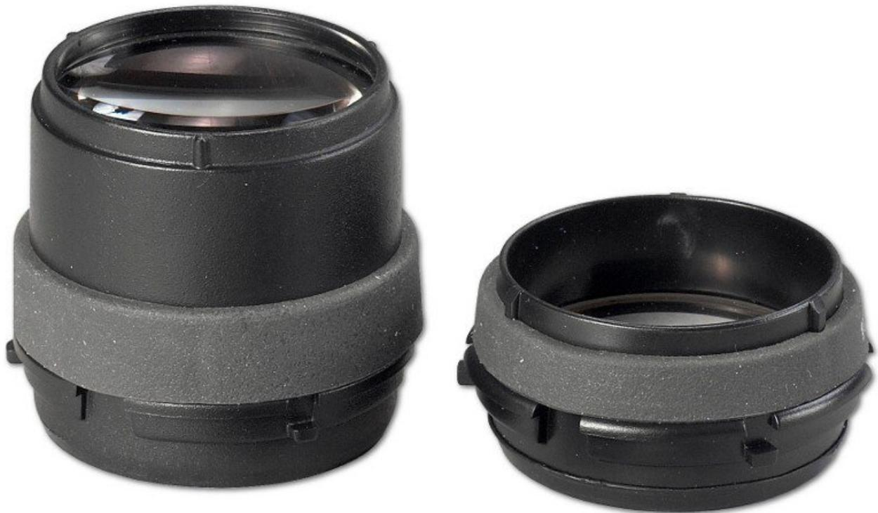
L'objectif de haute qualité Vision Engineering MCO-006 avec un grossissement de 6x est adapté pour être utilisé avec le stéréomicroscope sans oculaire Mantis Compact. Il peut être inséré et retiré rapidement par simple rotation et verrouillage. La distance de travail est de 73 mm et le champ de vision de 19,2 mm.
