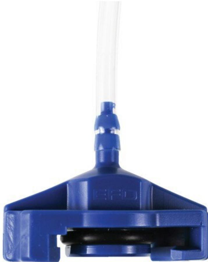
Conçus pour une mise en place rapide, ces adaptateurs légers à usage général sont dotés de fentes qui s'enclenchent solidement dans les languettes correspondantes sur le cylindre de la seringue. Tête d'adaptateur en acétal moulée en bleu, d'une seule pièce, avec joint torique NRB, tuyau d'air flexible en polyuréthane (5/32" OD x 3/32" ID), raccord rapide avec fiche et clip de sécurité.
