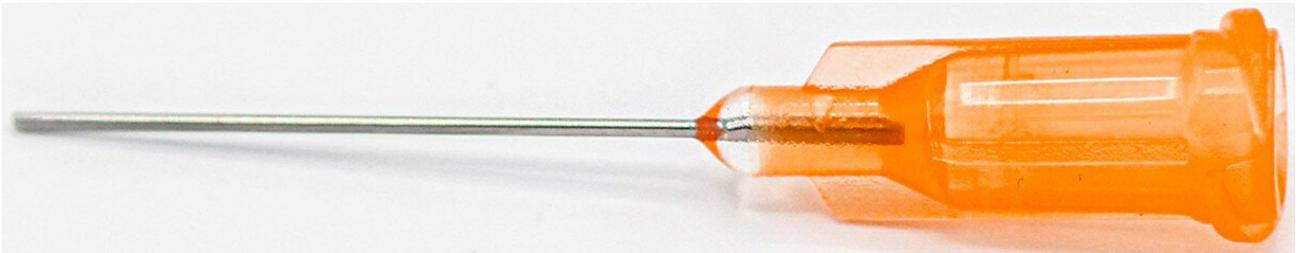
Les aiguilles de la série TE sont composées d'un corps en polypropylène sans silicone ni chlorure, d'un filetage à double hélice et d'une canule en acier inoxydable. Les aiguilles de dépose sont exemptes de bavures et ont des canules polies par électrolyse, ce qui garantit un flux de produit constant. Disponible en unités d'emballage de 50 pièces.
