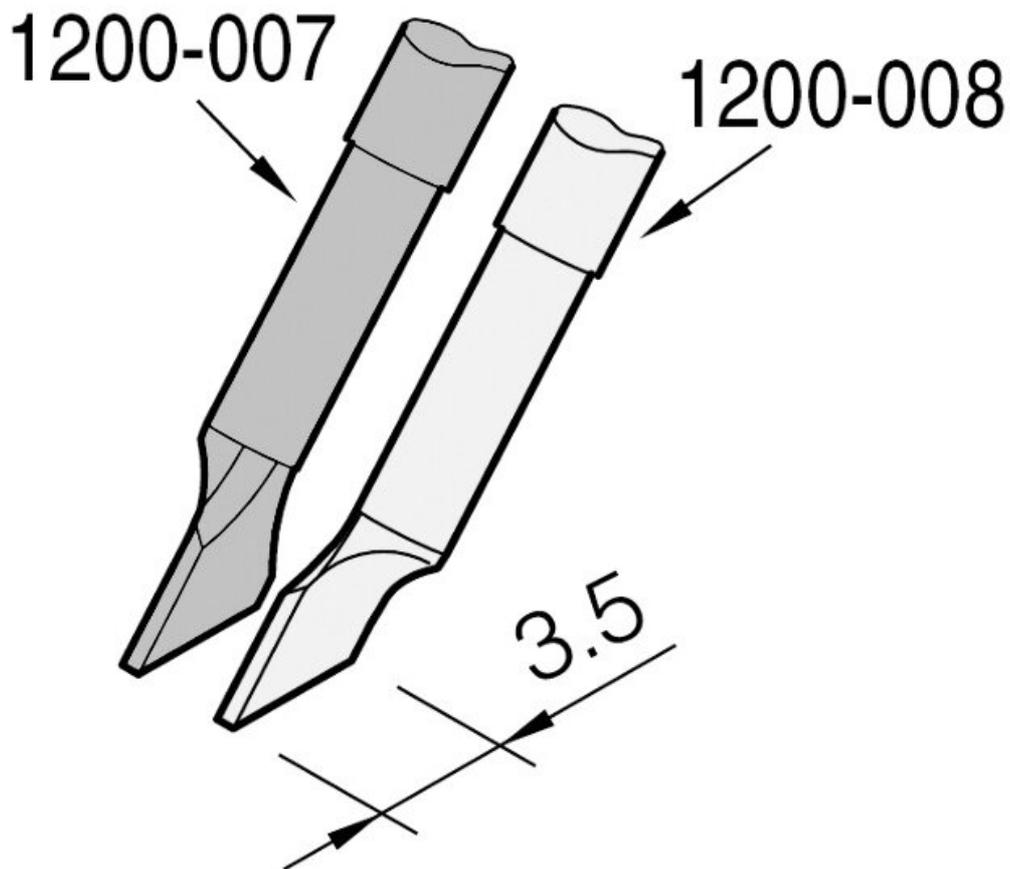
Les pannes à souder de la série C120 conviennent pour les micro-pincettes PA120. Elles peuvent être utilisées pour souder et dessolder les composants de puces ou les Dual-in-Line.
