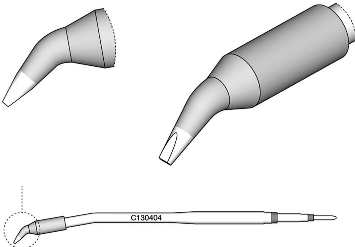
La série de pannes à souder C130 convient pour la pièce à main AP130 et dispose de pointes arquées parfaitement adaptées à la position du fil d'étain. Les pointes peuvent être orientées à l'aide de la protection anti-rotation située sur la pièce à main.
