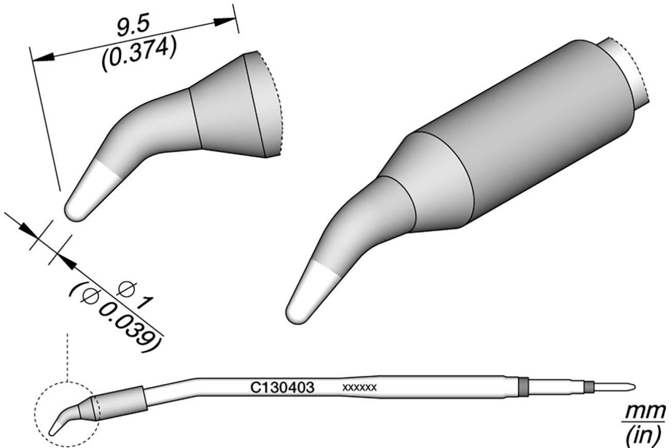
La série de pannes à souder C130 convient pour la pièce à main AP130 et dispose de pointes arquées parfaitement adaptées à la position du fil d'étain. Les pointes peuvent être orientées à l'aide de la protection anti-rotation située sur la pièce à main.
