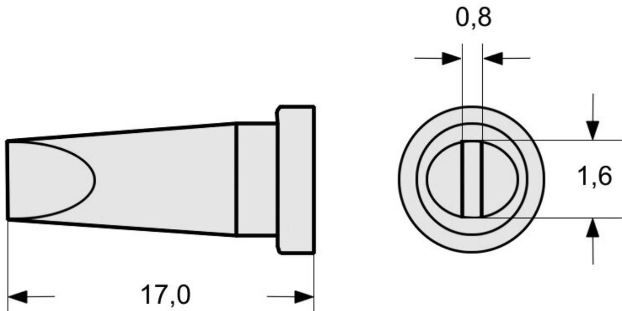
Avec protection anti-torsion pour une utilisation dans les systèmes de soudage automatisé, associé au corps chauffant HER
