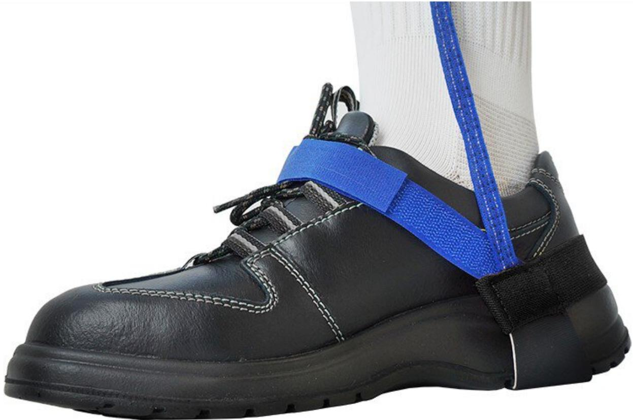
La talonnette ESD de Safeguard est un accessoire important pour une mise à la terre correcte des personnes. Elle a une résistance de fuite de 1 MOhm et une fermeture velcro. La talonnette sert à évacuer l'électricité statique des pieds et à éviter ainsi d'endommager les appareils et les composants électroniques. La résistance de décharge de 1 MOhm garantit que la décharge de l'électricité statique est efficace et sûre. La bande est bleue/noire et convient aux chaussures de ville à talon plat.
