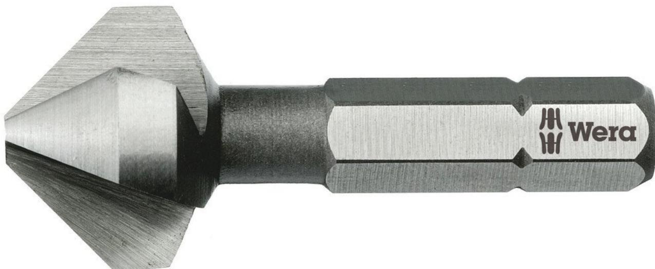
Hochwertiger 3-nutiger Kegelsenker-Bit zum Entgraten, Fasen und Senken. Die feinabgestimmte Materialelastizität garantiert hohe Standzeiten. Einwandfreie Spanabfuhr und geringe Verkantungsgefahr gewährleisten angenehmes Arbeiten. Schneideteil nach DIN 335-C, 90° mit 3 Schneiden. 1/4"-Sechskant passend für Halter mit Aufnahme nach DIN ISO 1173-D 6,3.
