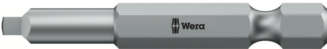
BiTorsion Bits für Innenvierkant-Schrauben mit Torsionszone, in die bei Belastungsspitzen kinetische Energie abgeleitet wird. Dadurch signifikante Erhöhung der Produktlebensdauer. Mit passendem Halter bestmögliche Lebensdauer. Zähhart, für den universellen Einsatz. 1/4" Sechskant, passend für Halter nach DIN ISO 1173-F 6,3.
