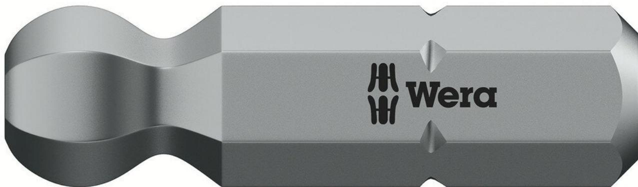
Zähharte Wera Bits für Innensechskantschrauben, für den universellen Einsatz. Durch die kugelförmigen Abtriebsprofile ist ein Auslenken oder Schwenken der Werkzeugachse zur Schraubenachse möglich, so dass dadurch "um die Ecke" geschraubt werden kann.
