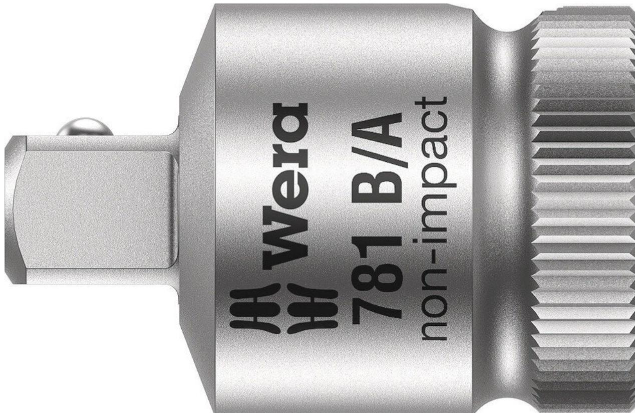
Verbindungsteil von 3/8"-Innenvierkant auf 1/4"-Außenvierkant. Für die Hand- und Maschinenbetätigung (non impact), mit Kugelfangrille zur sicheren Arretierung der Nuss, Rändelung am hinteren Ende für hohe Griffigkeit bei der Handbetätigung; Chrom-Vanadium, mattverchromt.
