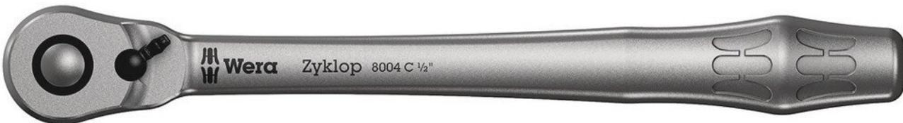
Knarre Zyklop Metal mit Umschalthebel. Schlanke Bauform zum Arbeiten auch in sehr engen Bauräumen. Aufgrund der Feinverzahnung mit 72 Zähnen wird ein niedriger Rückholwinkel von 5° ermöglicht. Mit Umschalthebel für einen bequemen Richtungswechsel. Mit sicherer Nussverriegelungsfunktion. Geschmiedete Vollmetallknarre (Chrom-Molybdän) für besonders hohe Robustheit bei langer Lebensdauer.
