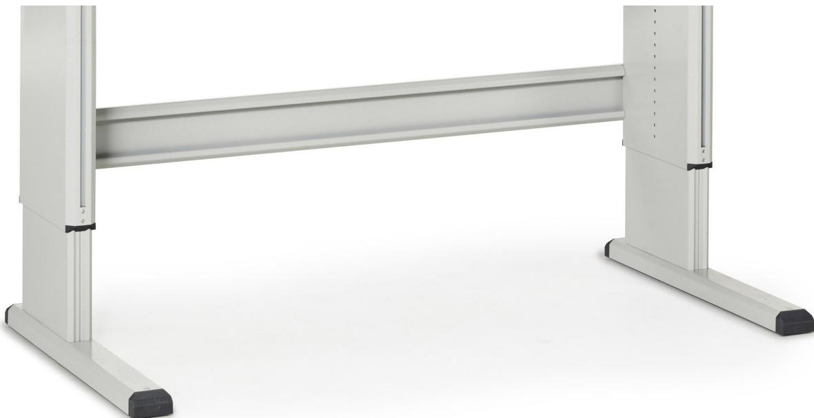
Für den mobilen Einsatz eines Concept Ergo Arbeitstisches in Kombination mit Rollen wird der Einsatz eines Querverbinders empfohlen. Dieser dient zur Erhöhung der Stabilität des Gestells bei Verfahrbewegungen. Der Querverbinder ist ausschließlich zur Verstärkung der Rahmenkonstruktion vorgesehen und nicht für die Montage von Zubehörteilen geeignet.
