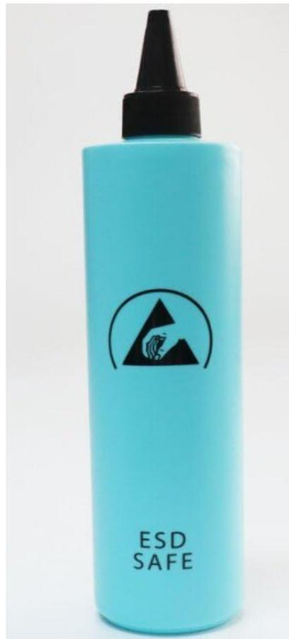
Blaue dissipative Flasche, die im EPA-Bereich verwendet werden kann. Gegossenes antistatisches Polyethelen. Gute Beständigkeit gegen Alkohol, Lösungsmittel und andere Chemikalien.
