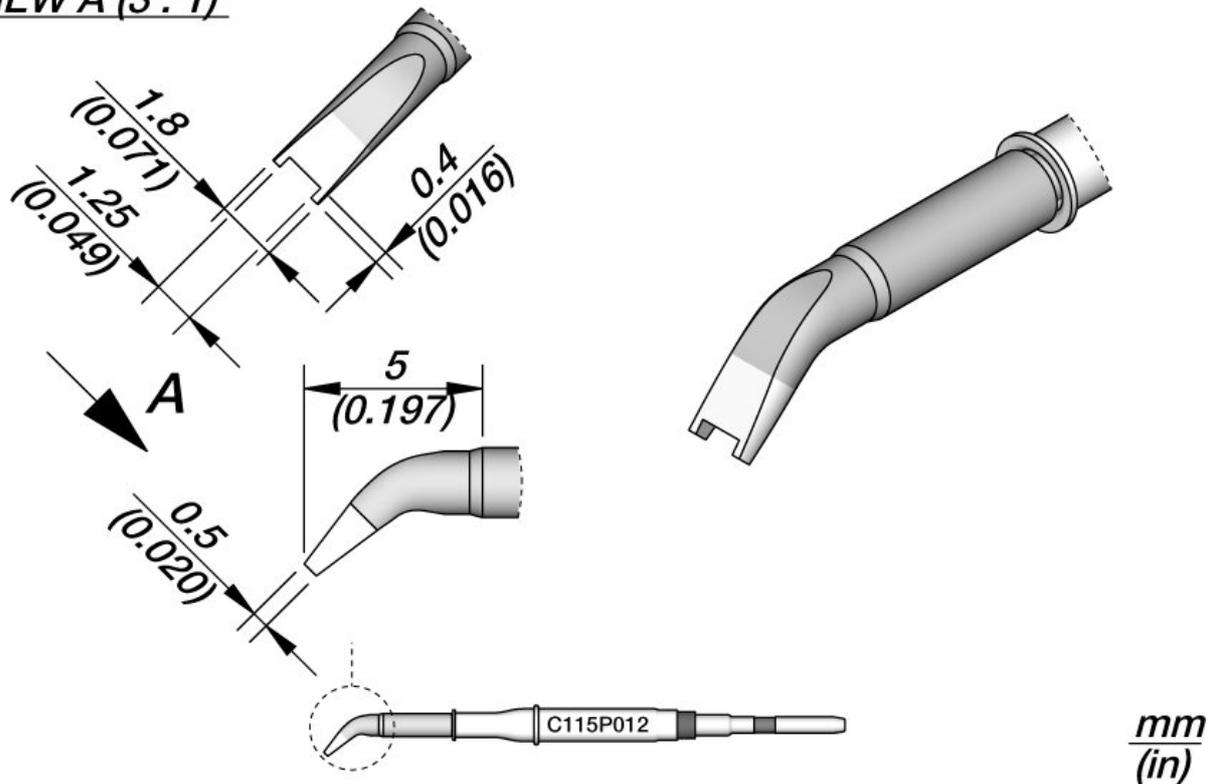
Die C115-Patronen sind für das Entlöten von Chipkomponenten geeignet. Sie arbeiten mit dem NT115 Nano Handle und erfüllen die anspruchsvollsten Vorschriften. JBC Long Life Tips bieten eine sofortige Erwärmung, eine hervorragende Wärmeübertragung und eine lange Lebensdauer. Dank des JBC Most Efficient Soldering System und der Sleep & Hibernation Funktionen halten sie 5 mal länger als andere Marken.
