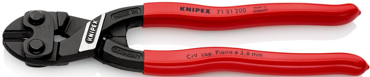
Mit Präzisionsschneiden für weichen, harten Draht sowie Pianodraht. Schneidet Bauteile wie Bolzen, Nägel, Niete usw. bis Ø 5,2 mm. Besonders hohe Schneidleistung bei geringerem Kraftaufwand durch höchst effiziente Gelenkkonstruktion. Mit Aussparung zum leichteren Schneiden von dickeren Drähten. Schneiden zusätzlich induktiv gehärtet, Schneidenhärte ca. 62 HRC. mit Greiffläche unter dem Gelenk zum Greifen und Ziehen von Drähten ab Ø 1,0 mm. SB-Karte/Blister.
