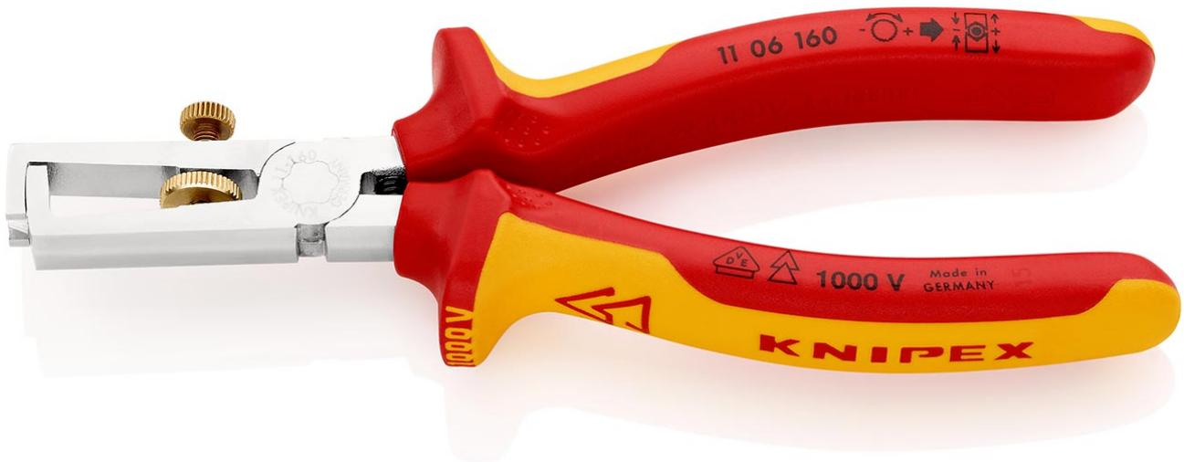
Für ein-, mehr- und feindrähtige Leiter mit Kunststoff- oder Gummiisolation max. Ø 5 mm oder 10 mm<sup>2</sup> Leiterquerschnitt. Einfache Verstellung auf den gewünschten Draht- oder Litzendurchmesser durch Rändelschraube und Kontermutter. SB-Karte/Blister.
