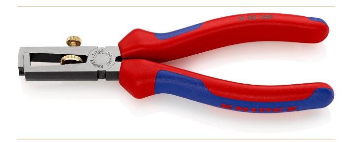
Für ein-, mehr- und feindrähtige Leiter mit Kunststoff- oder Gummiisolation max. Ø 5 mm oder 10 mm<sup>2</sup> Leiterquerschnitt. Einfache Verstellung auf den gewünschten Draht- oder Litzendurchmesser durch Rändelschraube und Kontermutter. SB-Karte/Blister.
