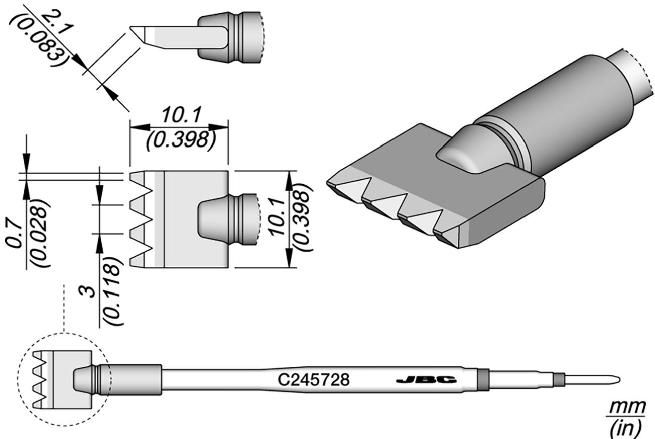
Dies ist eine spezielle Kartusche mit einer Messerspitze, die für das Schlepplöten von Multipads entwickelt wurde.
