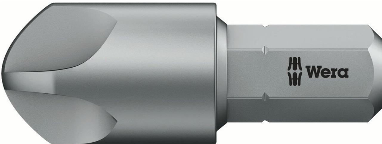
Hochwertige Bits für TORQ-SET® Schrauben. Aufgrund stärkerer Flanken als beim konventionellen TORQ-SET® Profil ergeben sich ca. 70% mehr Bruchdrehmoment bei passgenauem Sitz in der Schraube und eine damit verbundene längere Lebensdauer des Werkzeugs. Zähhart, für den universellen Einsatz. 1/4"-Sechskant, passend für Halter nach DIN ISO 1173-D 6,3.
