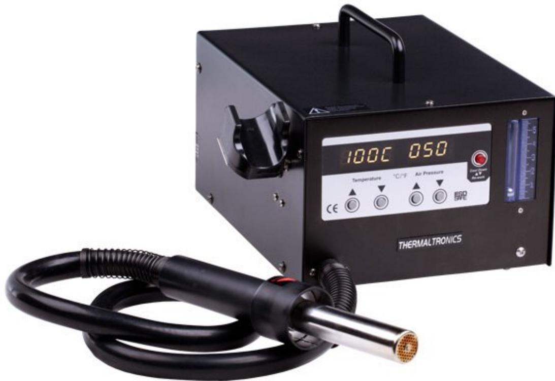
Das TMT-HA600-Heißluftgerät verfügt über eine große Membranpumpe und ein leistungsstarkes 1300-W-Heizgerät, das für schwierigere Anwendungen bei der Entfernung und dem Reflow von oberflächenmontierten Bauteilen entwickelt wurde.
