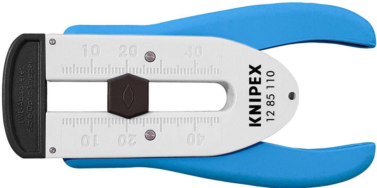
Zum Entfernen von Primär-Coating bei Glasfaserkabeln Ø 0,125 mm. Klinge Ø 0,16 mm, Bohrung für Kabelzuführung Ø 0,35 mm. Einstellbarer Längenanschlag von 5-45mm. Gehäuse: Kunststoff, schlagfest.
