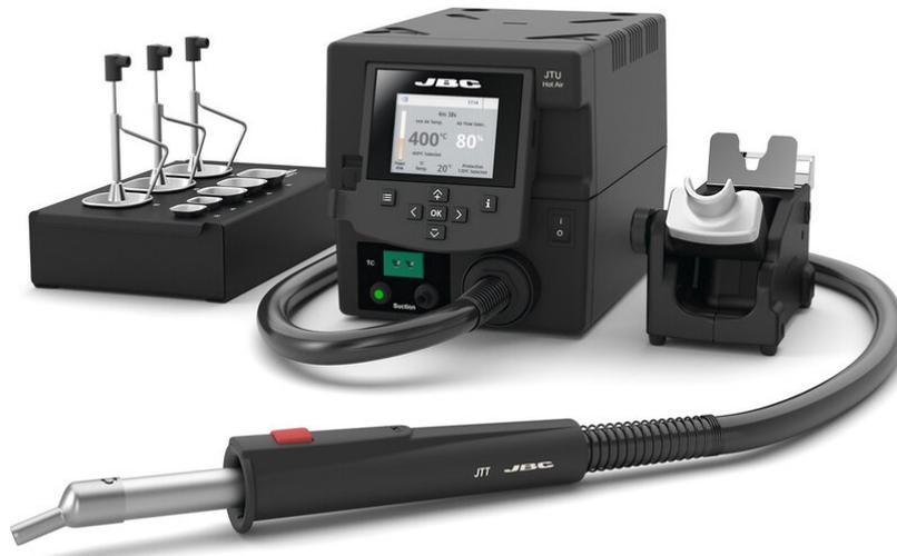
Die JBC JTSE-2B ist eine hochentwickelte Heißluftstation aus der Premium-Line von JBC, konzipiert für anspruchsvolle SMD-Reparaturen und Leiterplatten-Nacharbeiten. Mit einer Leistung von 700 W und einem Temperaturbereich von 150–450°C ermöglicht sie eine präzise und effiziente Entlötung von Bauteilen wie QFPs und PLCCs.
