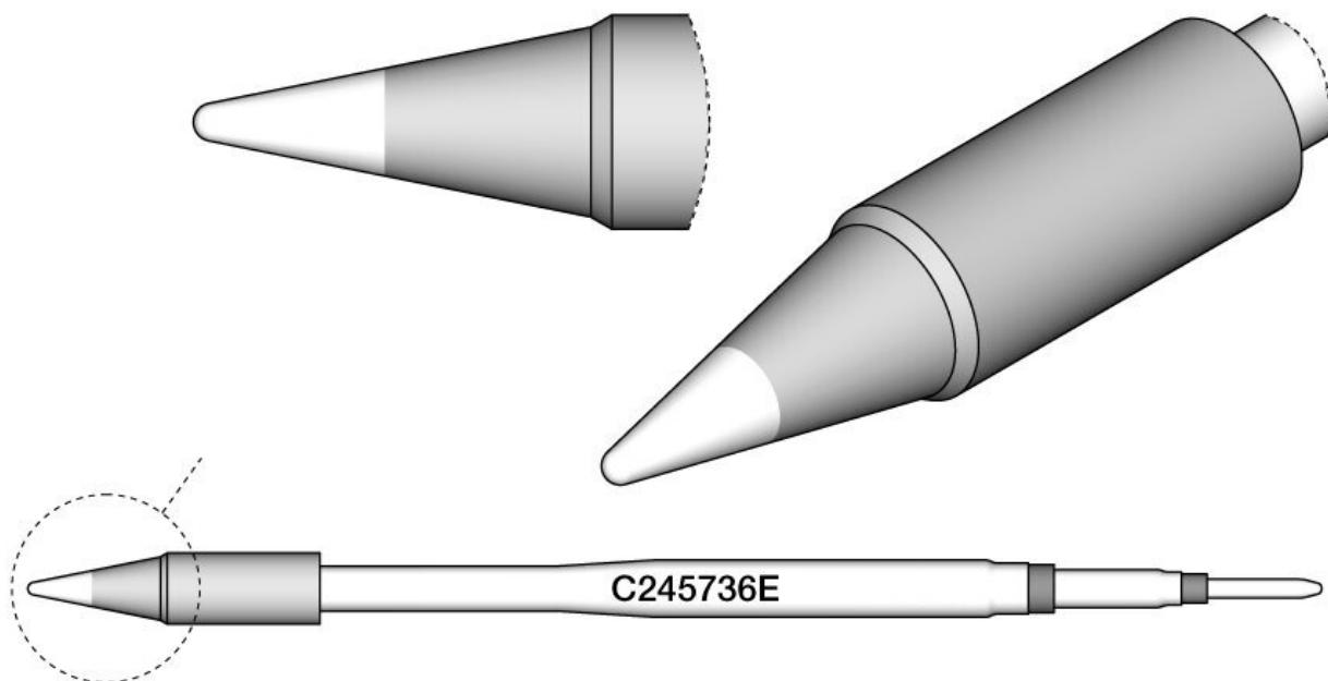
Die C245E-Patronen wurden mit einer dickeren Eisenschicht entwickelt, was diese Spitze ideal für harte und sich wiederholende Arbeiten in der Massenproduktion macht. Eine dickere Eisenschicht reduziert die thermische Effizienz.
