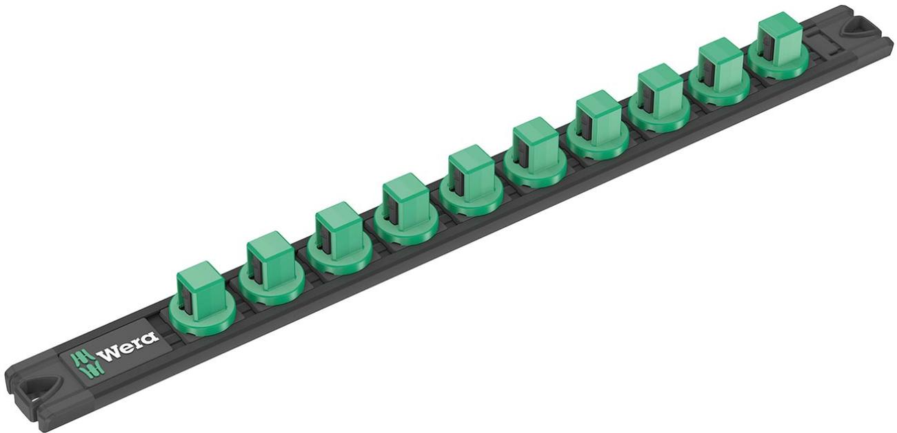
1 Nuss-Magnetleiste, unbestückt. Für bis zu 10 Steckschlüsseinsätze und/oder Bitnüsse mit 1/2"-Antrieb. Die Magnetleiste ermöglicht die temporäre Anbringung an metallischen Oberflächen und verfügt dank der Twist to unlock Funktion über eine sichere Nussverriegelung und -entriegelung.
