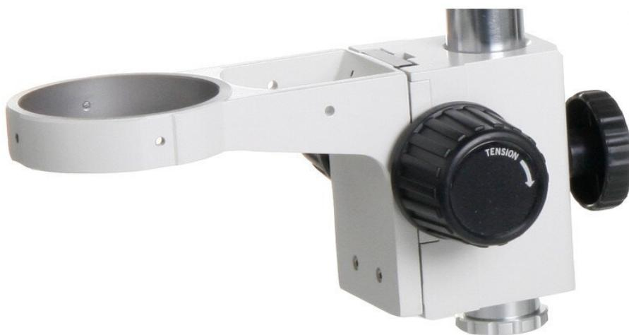
Kopfhalter geeignet für NZ.9000/9005/9015/9017/9020/9030 Säulen-Stative. Für Säulendurchmesser 32mm und Objektivdurchmesser 76mm
