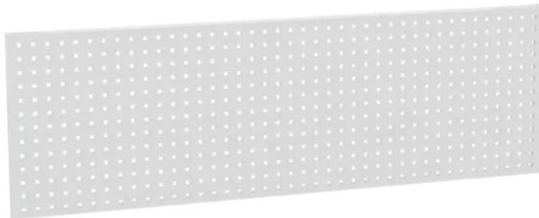
Werkzeughalterwand aus Metall mit einer Dicke von 1,2 mm. Quadratische 10x10 Perforation mit einem Abstand von 35mm. Ableitende Pulverbeschichtung in der Farbe hellgrau (RAL 7035).
