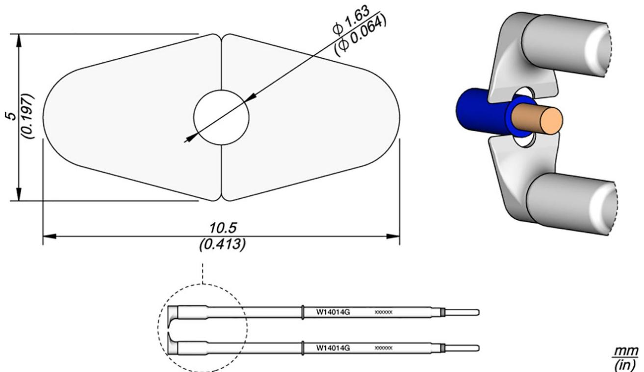
Die W14014G ist speziell für das Abisolieren von Hochtemperaturkabeln aus thermostabilen Materialien wie Teflon\*, Kapton\*, Silikonkautschuk usw. mit einem Querschnitt von 14 AWG (1,63 mm / 0,0642 in) ausgelegt.
