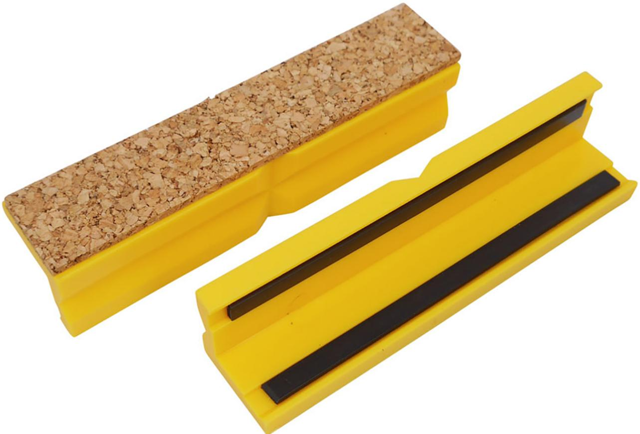
Die Schonbacken aus Kunststoff sitzen, aufgrund ihrer doppelten Magnetleiste, perfekt an jedem Schraubstock mit Stahlbacken. Der elastische und feste Korkbelag schützt empfindliche Teile vor Kratzern oder Beschädigungen. Durch die Längs- und Querrille können auch runde Gegenstände sicher eingespannt werden.
