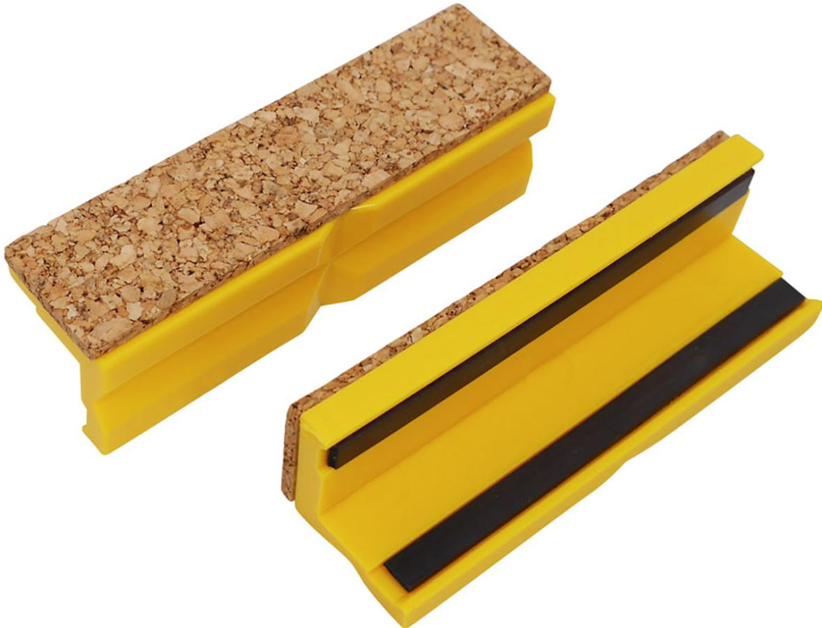
Die Schonbacken aus Kunststoff sitzen, aufgrund ihrer doppelten Magnetleiste, perfekt an jedem Schraubstock mit Stahlbacken. Der elastische und feste Korkbelag schützt empfindliche Teile vor Kratzern oder Beschädigungen. Durch die Längs- und Querrille können auch runde Gegenstände sicher eingespannt werden.
