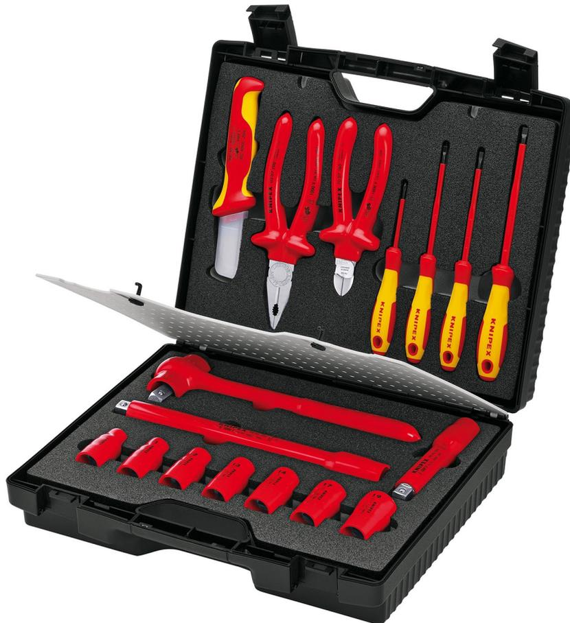
Schlagfester Kunststoffkoffer. Schaumstoffeinlage mit präzisen Mulden für die Aufnahme der Werkzeuge. Bestückt mit einem Sortiment gebräuchlicher isolierte KNIPEX-Werkzeuge für Arbeiten an elektrischen Anlagen. Alle Werkzeuge sind stückgeprüft und erfüllen die Anforderungen von ASTM F1505 und IEC 60900. Abmessungen, außen (B x H x T): 380 x 85 x 260 mm. Abmessungen, innen (B x H x T): 335 x 70 x 230 mm. - Innenfächer: 17Stk
