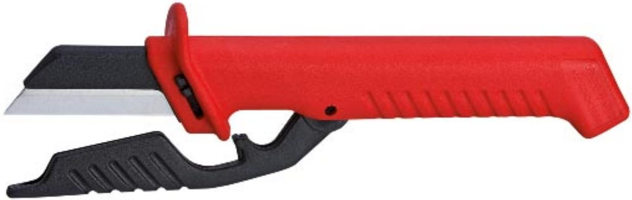
Gerade Klinge mit Spezialschliff; auswechselbar. Mit klappbarem Klingenschutz, unverlierbar im Griff integriert. Klingentrücken zur Vermeidung von Kurzschlüssen mit Kunststoff überzogen. Griff mit Abgleitschutz. Griff mit Abgleitschutz. - Klingenlänge: 50mm - VDE-geprüft: Ja
