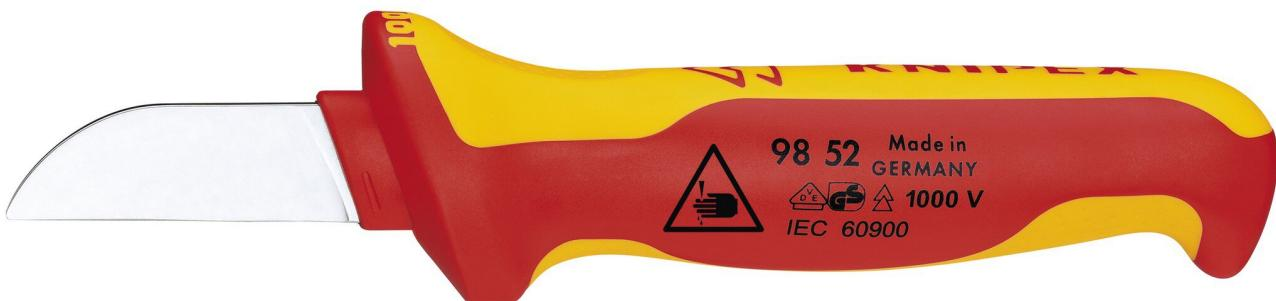
Ergonomisch gestaltete Griffform mit angenehm gestaltetem Abgleitschutz. Mehr Sicherheit durch rutschfeste Weichkomponente. Gute Kraftübertragung beim Ziehen des Messers durch Daumenmulde und "Fingerhaken" am Griffende. Stabile, feststehende Klinge mit gerader Schneide. Transparente Schutzkappe. - Klingenlänge: 50mm - VDE-geprüft: Ja
