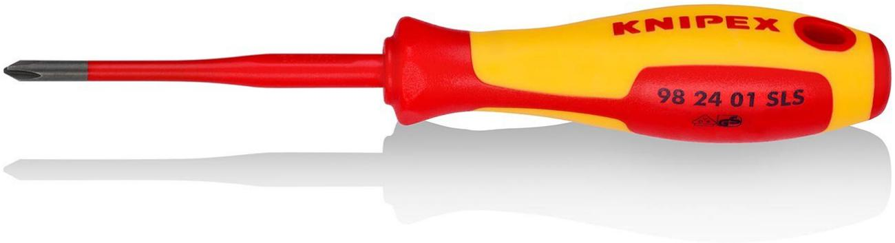
Schraubendreher (Slim) PlusMinus Antriebsspitze für PlusMinus-Profileschrauben. Einsatz bei Elektroinstallations-Komponenten wie z. B. Sicherungsautomaten.: Reduzierter Klingenisolationsdurchmesser für tiefliegende Feder- und Schraubelemente.: Ergonomisch optimierter 2-Komponenten-Griff für ermüdungsarme und handschonende Kraftübertragung. Rollhemmende Griffform. - Größe: PH/S 1 - Klingenlänge: 80mm - Grifflänge: 107mm - unisolierte Klingenlänge: 15mm - VDE-geprüft: Ja
